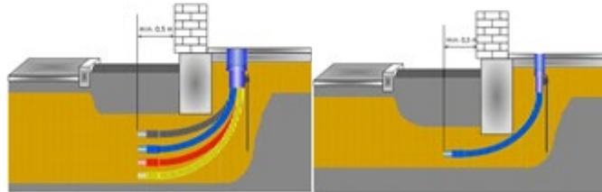
Gebäudeeinführungen sind nach den geltenden Vorschriften für Bauwerksdurchdringungen und deren Abdichtung für erdverlegte Leitungen auszuführen. Die Gebäudeeinführung ist Bestandteil des Gebäudes. Für den Einbau und die Abdichtung ist der Anschlussnehmer verantwortlich. Die Erstellung der Gebäudeeinführung durch den Netzbetreiber ist gesondert zu vereinbaren.
