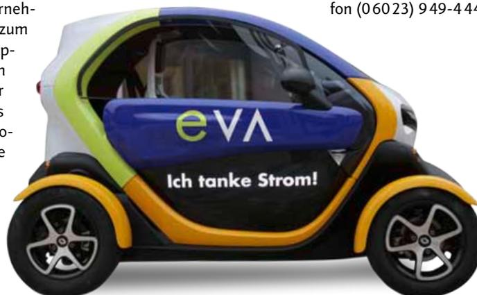
Um den EVA-Twizy zu fahren, braucht es lediglich einen Führerschein der Klasse B. Die Handhabung ist denkbar einfach. Auch das Laden des Akkus dürfte keine Probleme bereiten. Einfach das mitgelieferte Ladekabel in eine ganz normale 230-Volt-Steckdose stecken und fertig. Nach dreieinhalb Stunden sollte die Batterie voll aufgeladen sein.
