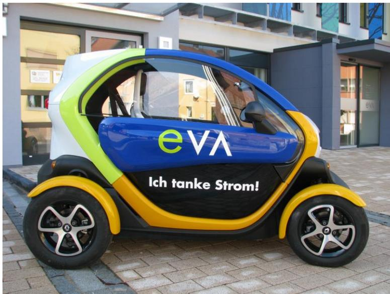
**Bildunterschrift:** Der elektrisch betriebene Stadtfliker der EVA ist 2,3 Meter lang und 1,2 Meter breit und hat eine Höchstgeschwindigkeit von 80km/h.
