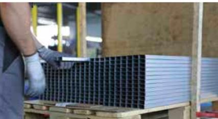
Die fertigen Profile werden für den Versand direkt von der Maschine auf die passende Palette gepackt.
