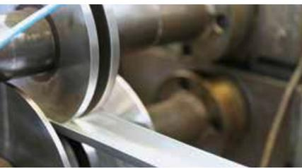
Das Metallband durchläuft mehrere Profilierstationen. Jedes dieser Werkzeuge verformt das Material etwas mehr, bis das Profil den Anforderungen entspricht.
