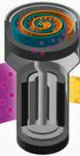
**SCHRITT 2** Verdichtung. Der entstandene Dampf wird in einem Kompressor stark zusammengepresst. Dadurch steigt seine Temperatur deutlich an – wie bei einer Fahrradpumpe, die beim Aufpumpen warm wird.
