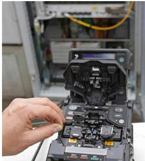
Mit einem speziellen Schweißgerät verbindet der Experte die haarfeinen Glasfasern
